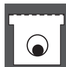
ELETRODUTO EM CANALETA VENTILADA
