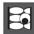
ELETRODUTO EM PAREDE ISOLANTE
